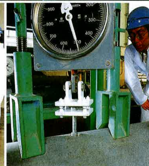
▲足場ボルト受口試験
