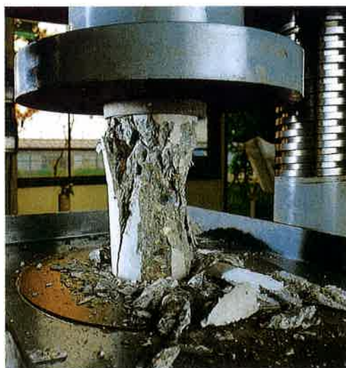
▲コンクリートの圧縮試験
