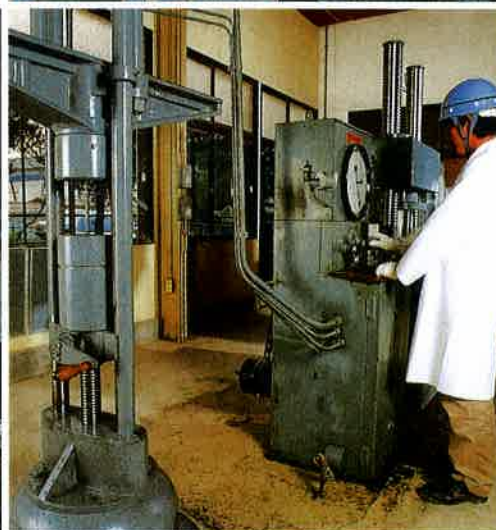
▲PC鋼棒強度試験
